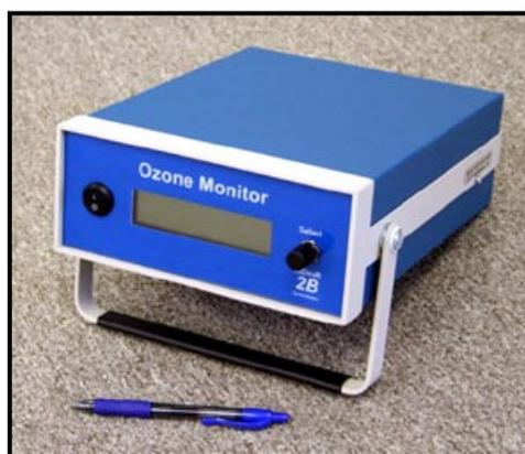
Photo 1 – Analyseur portable d'ozone utilisé sur l'agglomération durant l'été 2009.
